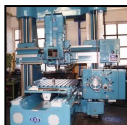
Obr. č. 86: Vyvrtávačky - stolová vodorovná, desková, souřadnicová, CNC stolová vodorovná.
