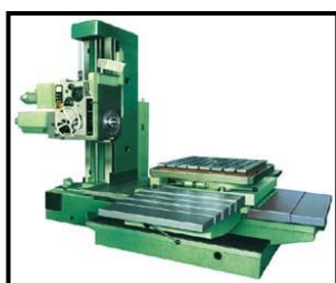
Obr. č. 86: Vyvrtávačky - stolová vodorovná, desková, souřadnicová, CNC stolová vodorovná.
