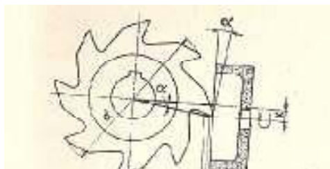
Obr. č. 40 Nastavení úhlu hřbetu frézky
