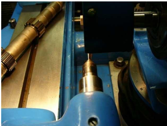
Obr.č. 197 - určení středu osy vůči ploše kotouče
