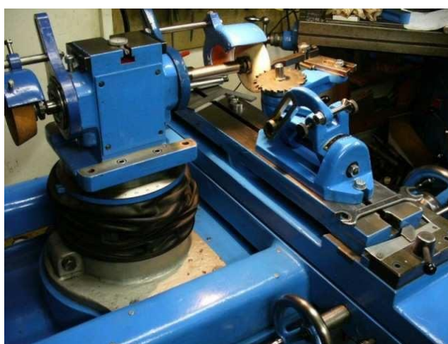
Obr.č. 171 - přípravek na broušení čel kotoučových fréz
