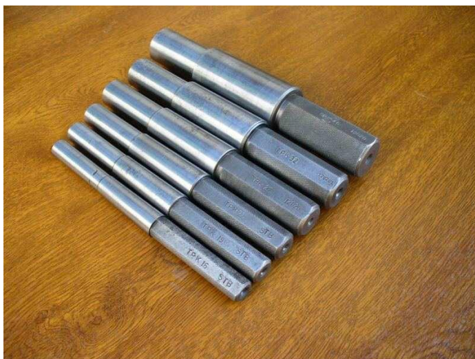
Obr.č. 189 - trny na průměrové broušení výhrubníků a výstružníků mezi hroty
