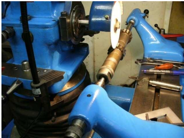
Obr.č. 207 - broušení odvalovací frézy kopírováním
