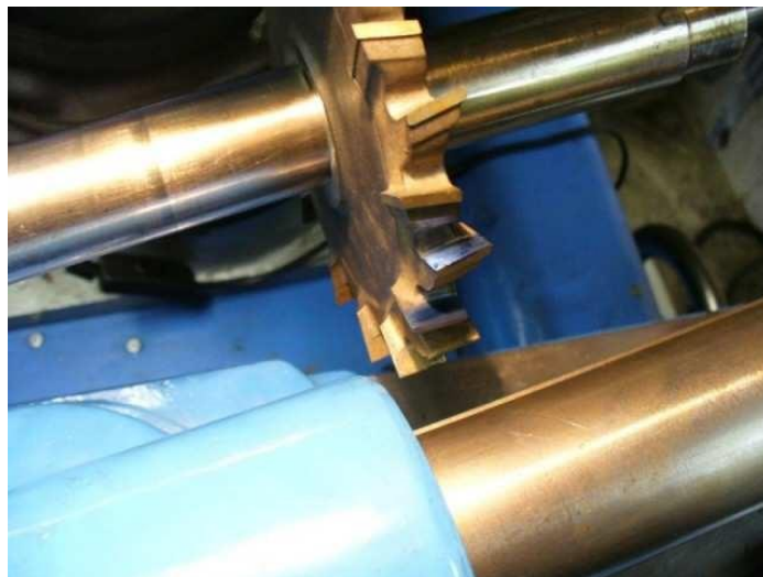
Obr.č. 183 - čelo bříty natřené fixem
