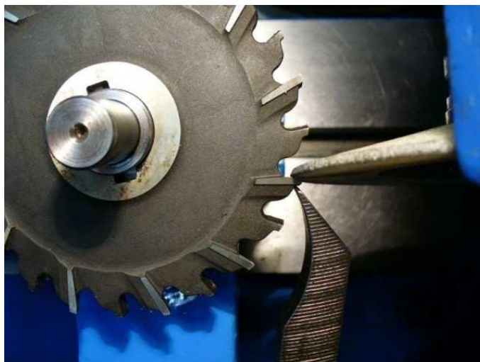
Obr.č. 177 - opěra opřená o zadní plochu bříty
