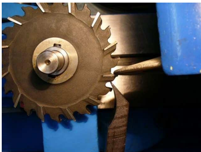
Obr.č. 176 - opěra opřená o zadní litou plochu zubu
