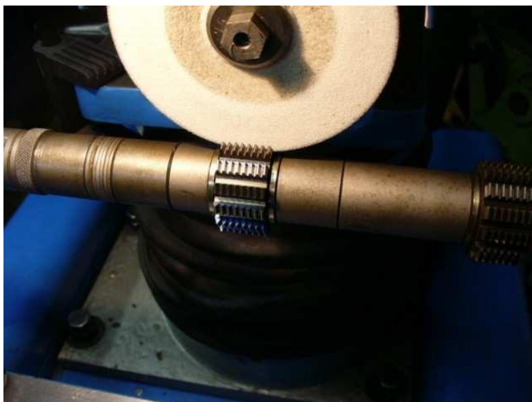
Obr.č. 199 - upnutí frézy do koníků a výškový posuv kotouče
