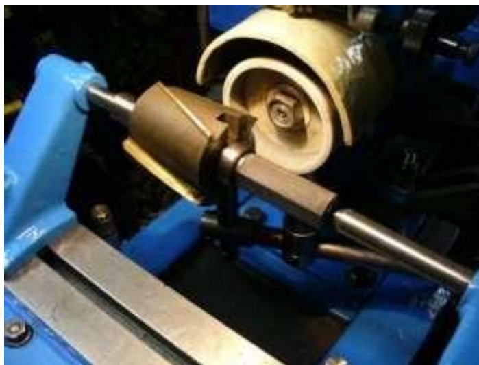
Obr.č. 190 - Broušení nástrčného výhrubníku na trnu mezi hroty
