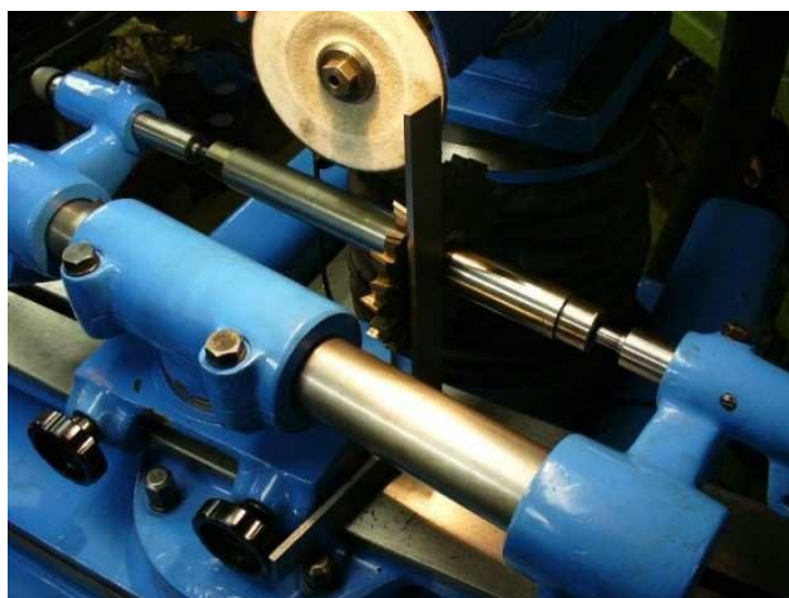
Obr.č. 184 - ustavení čela úhelníkem
