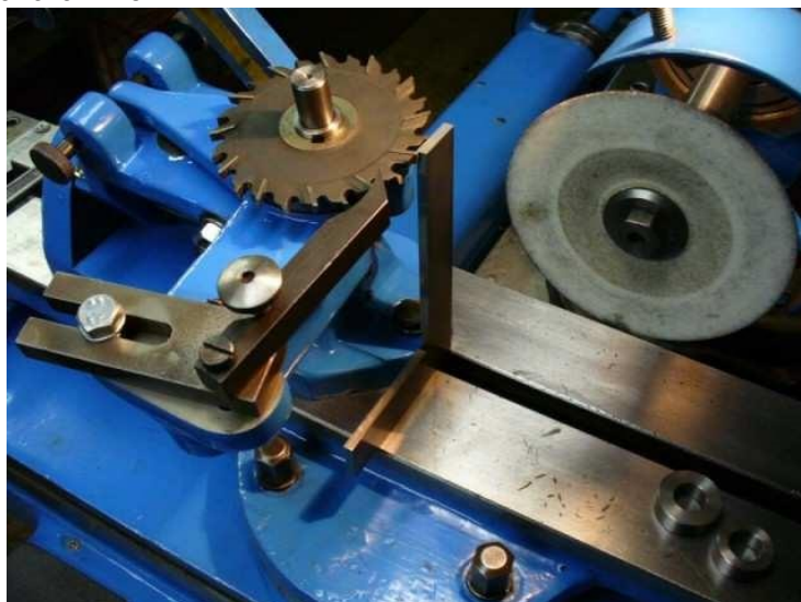
Obr.č. 174 - naklonění a zjištění úhlu pomocí úhelníku
