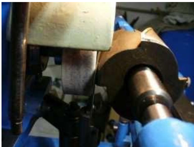
Obr.č. 191 - Detail opěry zubu při ostření
