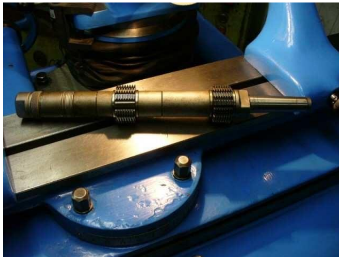
Obr.č. 195 - sesazené a upnuté frézy na trnu
