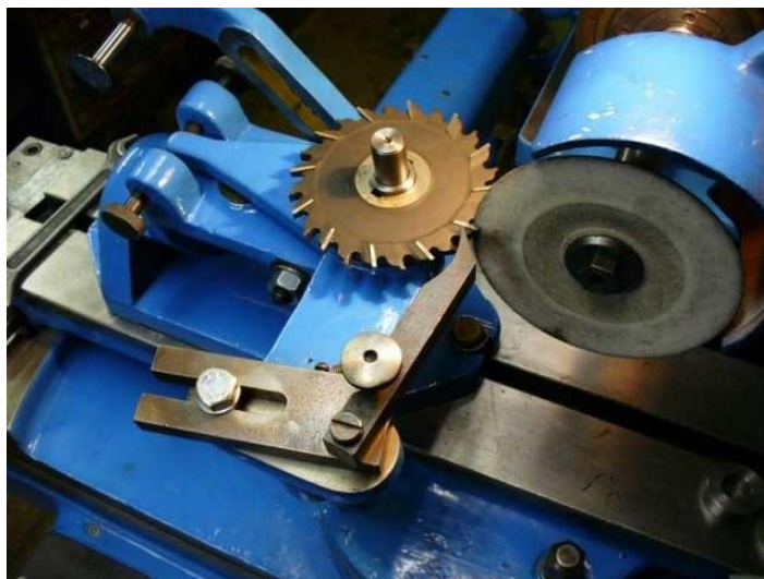
Obr.č. 175 - ustavení úhlu čela
