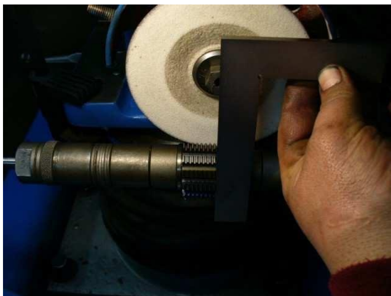
Obr.č 203 - střed brusného kotouče na začátku nástroje
