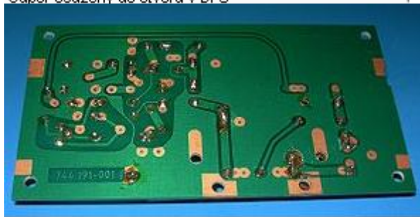
Ručně zapájený plošný spoj
