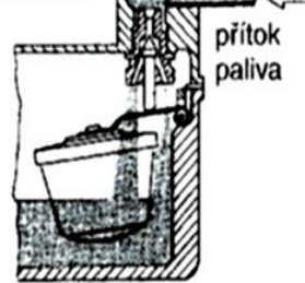
jehlový ventil plováku otevřen
