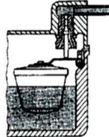
jehlový ventil plováku otevřen
