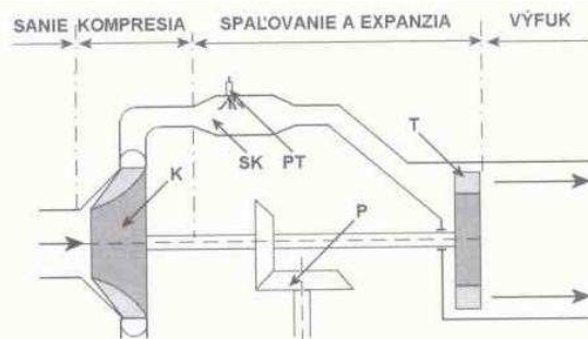
Fáze pracovního cyklu motoru s plynovou turbinou
