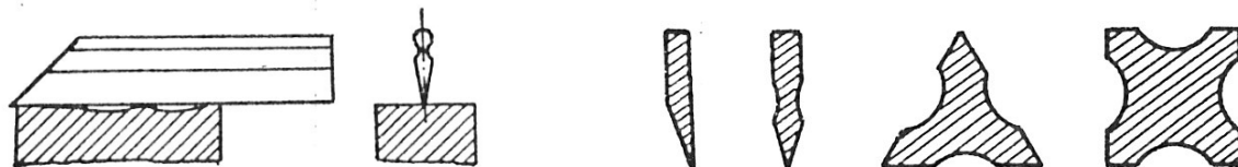
Kontrola rovinnosti nožovým pravítkem.
