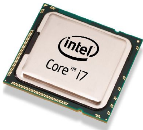
Šestijádrový procesor firmy Intel, technologie výroby 32 nm, tři úrovně vyrovnávací paměti cache(L1, L2, L3), frekvence jádra – 3,33GHz, socket - 1366
