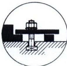
Obr. 3 Správné upnutí obrobku
