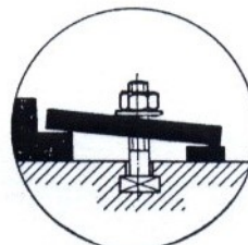
Obr. 4 Chybné upnutí obrobku
