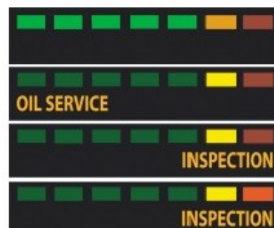
Obr. 4. Princip diodového systému SII (BMW).
