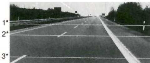
Obr. 2. Optopilot rozděluje zorné pole snímané kamerou do oblastí, které jsou následně analyzovány (úroveň jasů) a získané výsledky jsou předány řídicí jednotce.
