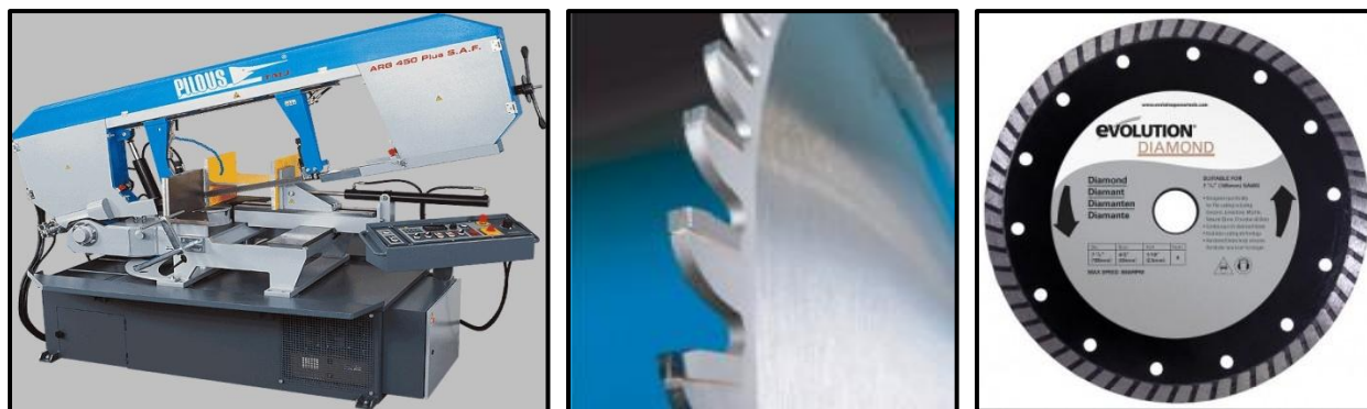
Obr. č. 44: Dělení materiálu pásovou pilou - pilový kotouč - diamantový kotouč.
