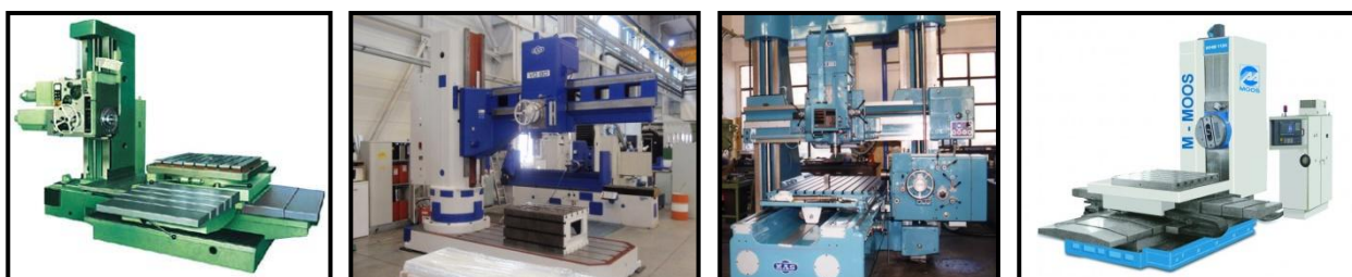
Obr. č. 86: Vyvrtávačky - stolová vodorovná, desková, souřadnicová, CNC stolová vodorovná.
