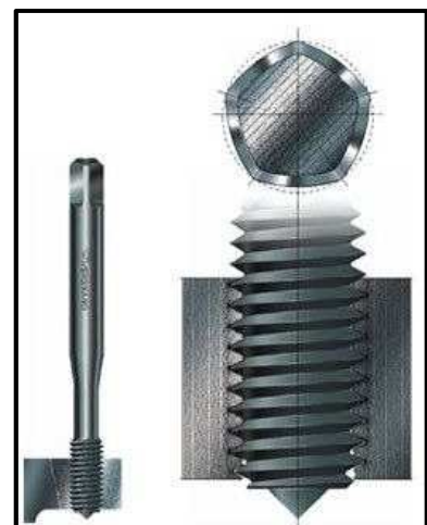
Obr. č. 14: Tváření závitů tvářecím závitníkem.
