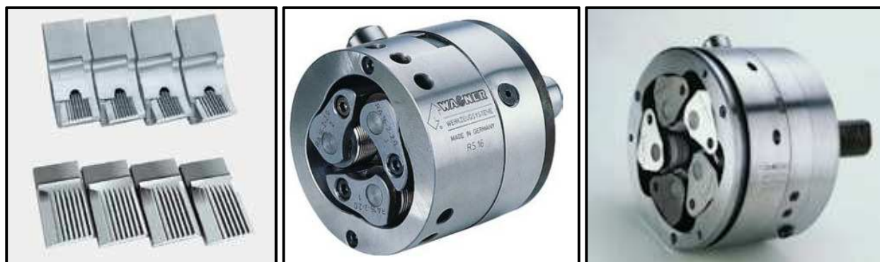
Obr. č. 11: Válcování závitů - ploché hřebenové čelisti a válcovací závitové hlavy s kotouči.
