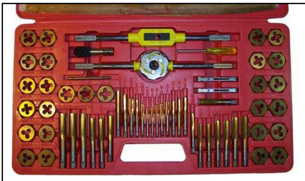
Obr. č. 2: Sada závitových čelistí a ručních závitníků s vratidly a závitovými měrkami.
